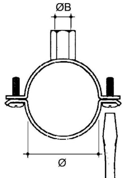
Nidax Rohrbefestigung PB-6064 Geeignet für Rohrdurchmesser 60 ...
