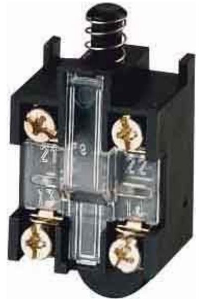
Eaton (Moeller) Schaltereinsatz 1S1Ö ATB11-3 Anzahl der Kontakte als Wechsler 0, Anzahl der Kontakte als Schließer 1, Anzahl der Kontakte als Öffner 1, Bemessungsbetriebsstrom  $I_e$  bei AC-15, 230 V 6A, Ausführung des elektrischen Anschlusses Schraubanschluss, Ausführung integrierbar, Montageart Seitenanbau, Fassung nicht zutreffend, IEC EN 60947-5-1, IP65, Weltmarktgerät, modulares Bausteinsystem, robuste Ausführung, elektroniktauglich nach IEC/EN 61131-33
