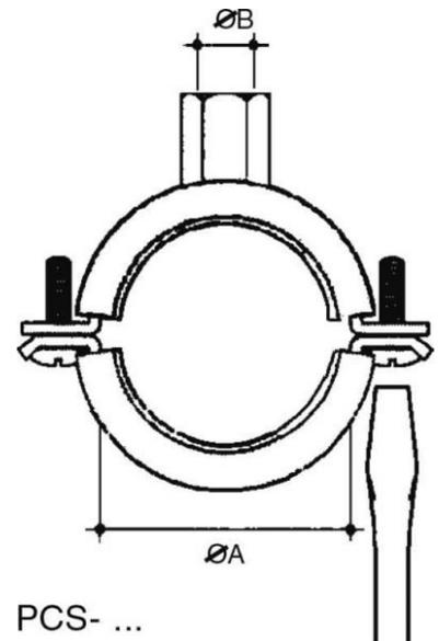
Niedax Rohrbefestigung PCS-6064 Geeignet für Rohrdurchmesser 60 ...
