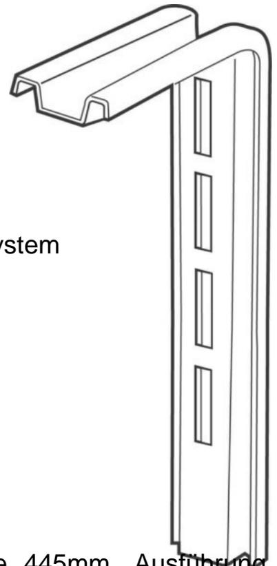
Legrand (Cablofil) Leichthängestiel PS 400 GC Länge 445mm, Ausführung U-Profil, Werkstoff Stahl, Werkstoffgüte sonstige, Oberfläche tauchfeuerverzinkt, Farbe ohne,
