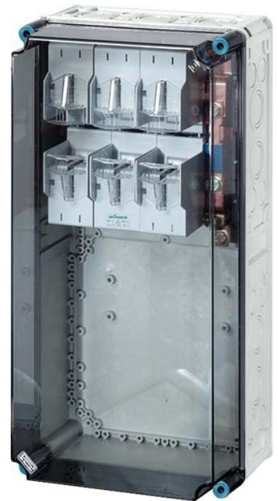
Hensel NH-Sicherungsgehäuse NH2, 400A Mi 6476 Sicherung NH-Sicherung, Bemessungsstrom 400A, Schutzart (IP) IP65, Platzierung auf Schienensystem universal, Anzahl der Gruppen 1, Werkstoff des Gehäuses Kunststoff, Mit transparentem Deckel, Höhe 600mm, Breite 300mm, Tiefe 214mm, Anbaumöglichkeit, Isolierstoffgekapselte Niederspannungs-Schaltanlage in Kastenbauform als \"Typgeprüfte Schaltgeräte-Kombination\" TSK nach IEC 60 439 -1 für Wandaufbau.
