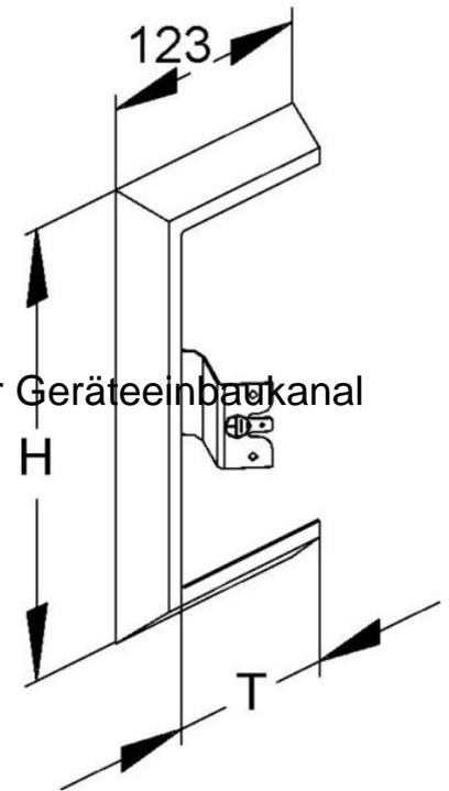
Nidax Wandrosette links DWRL 170T80 W Breite 170mm, Tiefe 80mm, Ausführung asymmetrisch, Montageart des Kanals Wand, Werkstoff Stahl, Werkstoffgüte sonstige, Oberfläche beschichtet,
