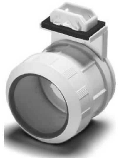
Houben Fassung G13 ws,D38,IP54,F13,3 108968 Werkstoff Kunststoff, Farbe weiß, Fassung G13, Befestigungsart Steckbefestigung, Nippelgewinde ohne, Für Lampen T38, Material PC, Innenteil PBT GF, T140, max.
