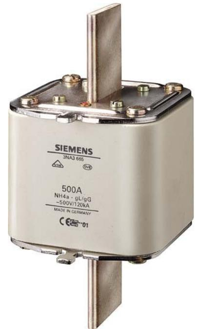
Siemens Indus.Sector NH-Sicherungseinsatz G4A1250A 500AC440VDC 3NA3682 Baugröße NH4a, Bemessungsstrom 1250A, Bemessungsspannung 500V, Betriebsklasse gL/gG (Ganzbereichs-Leitungsschutz/Ganzbereichs-Gerätesch.), Ausführung Kennmelder Stirnkennmelder, Mit spannungsführenden Griffflaschen, auch für Gleichspannungen bis 440 V.
