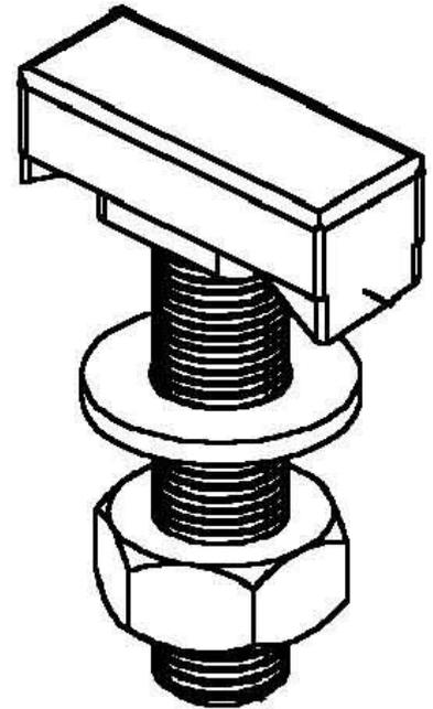
Niedax Hakenkopfschraube HK 512/50 F Werkstoff Stahl, Oberfläche feuerverzinkt, Gewindemaß metrisch 12, Länge 50mm, Kopfbreite 32,5mm, Geeignet für Montageschiene,
