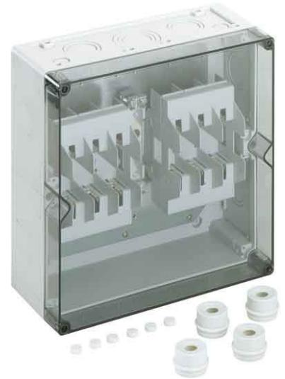
Spelsberg Sicherungsgehäuse AKi-S 202 Sicherung NH-Sicherung, Bemessungsstrom 100A, Schutzart (IP) IP65, Anzahl der Gruppen 2, Werkstoff des Gehäuses Kunststoff, Mit transparentem Deckel, Höhe 300mm, Breite 300mm, Tiefe 132mm, Anbaumöglichkeit, Bestückung: 2 x NH 00 3-polig 100 A Sicherungsunterteil (70 mm<sup>2</sup>), Schelle / Doppelschelle, 1 x PEN-Klemme (2 x 50 mm<sup>2</sup>, Schellenanschluss), montiert auf Montageplatte, mit IP 54 Anbaustutzen und Isolierstopfen
