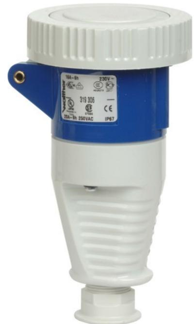
Walther Werke Kupplung 16A 3P 230V 6h IP67 319306 IEC-Stromstärke 16A, UL/CSA-Stromstärke (wenn UL-Ausführung gewünscht) 20A, Polzahl 3, Spannung nach EN 60309-2 230 V (50+60 Hz) blau, Uhrzeit-Stellung 6h, Kennfarbe blau, RAL-Nummer 5002, Schutzart (IP) IP67, Anschlussstechnik Schraubklemme, Steckrichtung gerade, Kabeleinführung Verschraubung, Werkstoff Kunststoff, Kupplung 16A 3P 230V 6h IP67 mit Trompetenverschraubung
