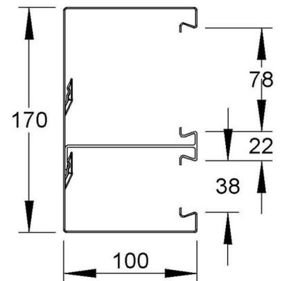
Niedax Gerätekanal-Unterteil DKU 170-78T100 R Breite 170mm, Tiefe 100mm, Länge 2000mm, Anzahl der Oberteile 2, Oberteilbreite 1 78mm, Oberteilbreite 2 38mm, Bauform rechteckig, Werkstoff Stahl, Werkstoffgüte sonstige, Halogenfrei, Oberfläche bandverzinkt und beschichtet, Farbe reinweiß, RAL-Nummer 9010, Ausführung Rückwand (Innenseite) durchlaufendes sonstiges Profil, Anzahl der
