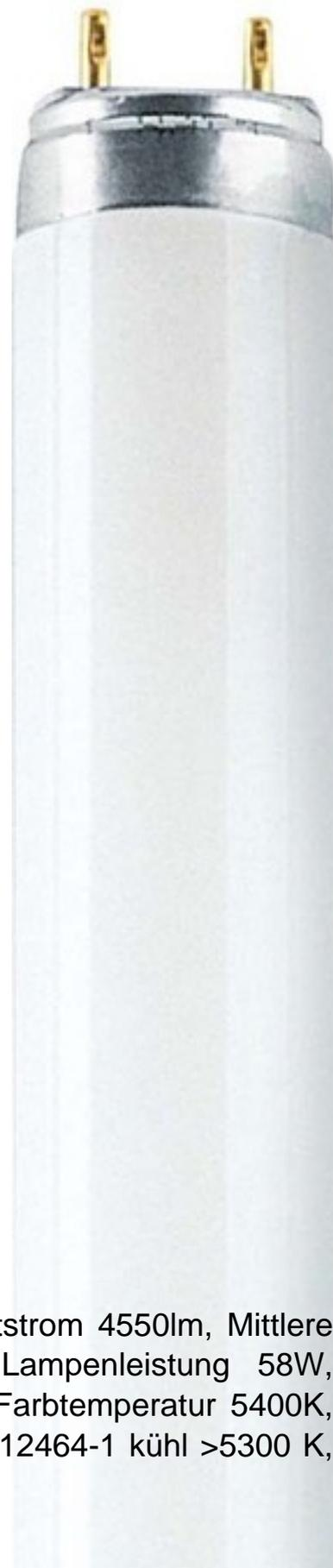
Osram Lumilux-DeLuxe Lampe 58W cws L 58/954 Lichtstrom 4550lm, Mittlere Nennlebensdauer 20000h, Energieeffizienzklasse A, Lampenleistung 58W, Sockel G13, Farbwiedergabestufe 90-100 (Klasse 1A), Farbtemperatur 5400K, Lampenform Stab, Lichtfarbe 954, Lichtfarbe gemäß EN 12464-1 kühl >5300 K,
