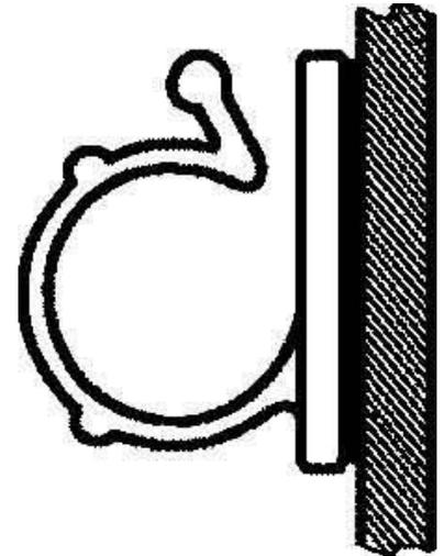
HellermannTyton Klebesockel RA3-N66-NA-C1 Nenndurchmesser 3mm, Durchmesser 3 ...
