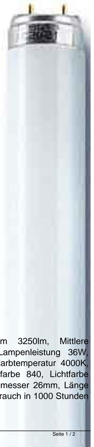
Osram Lumilux-Lampe L 36W/840 XXT Lichtstrom 3250lm, Mittlere Nennlebensdauer 90000h, Energieeffizienzklasse A, Lampenleistung 36W, Sockel G13, Farbwiedergabestufe 80-89 (Klasse 1B), Farbtemperatur 4000K, Lampenform Stab, Lampenlichtausbeute 92lm/W, Lichtfarbe 840, Lichtfarbe gemäß EN 12464-1 neutral 3300 bis 5300 K, Rohrdurchmesser 26mm, Länge 1200mm, Anwendung allgemein, Gewichteter Energieverbrauch in 1000 Stunden
