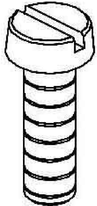
Niedax Schraube Z M5X16 Werkstoff Stahl, Werkstoffgüte 4.8 (Stahl), Oberfläche galvanisch/elektrolytisch verzinkt, Kopfform Zylinderkopf, Gewindemaß metrisch 5, Länge 16mm, Schraubensystem Schraubenschlitz, Zylinderkopfschraube mit Schlitz, DIN 84
