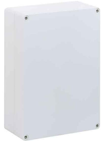
Spelsberg Leergehäuse TK PS 2518-8f-o Höhe 254mm, Breite 180mm, Tiefe 84mm, Einbautiefe 70mm, RAL-Nummer 7035, Anbaumöglichkeit, Werkstoff des Gehäuses Kunststoff, Oberfläche sonstige, Schutzart (IP) IP66, Art des Deckels geschlossen, IP 66, 254 x 180 mm Höhe: 84, Leergehäuse Ui=690 V, Kasten und Deckel: Polystyrol, grau ähnlich RAL 7035
