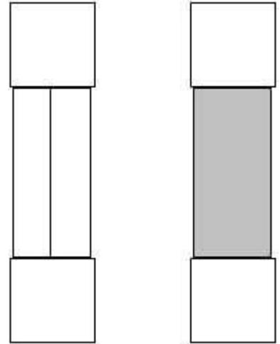
Eska G-Sicherungseinsatz M 16A 5x20mm 521.030 Auslösecharakteristik mittelträge (MT), Ausführung Glassicherung, Bemessungsstrom 16A, Bemessungsspannung 250V, Abmessungen 5x20 mm, Aufbau als Glasrohr mit Löschmittelfüllung mit Messingkappen und vormontierten Aufsteckhülsen mit Drahtenden zum einlöten nach EN 60068-2-20
