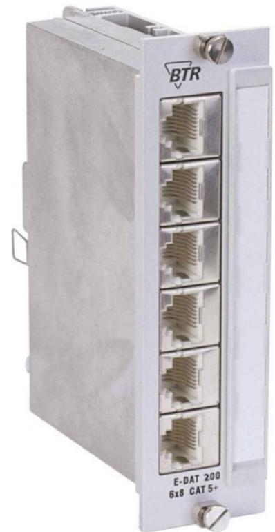
Metz Connect Verteilermodul E-DAT 6x8 Modul 3HE 130852-E Anzahl der Buchsen/Kupplungen 6, Geeignet für Anzahl Buchsen/Kupplungen 6, Steckverbindertyp RJ45 8(8), Geschirmt, Kategorie 6, Anschlussart LSA, Anzahl der Höheneinheiten (HE) 3, Farbe Silber, Montageart sonstige, Höhe 128,4mm, Breite 35,2mm, Tiefe 102,8mm, Modulgehäuse aus Zinkdruckguss.
