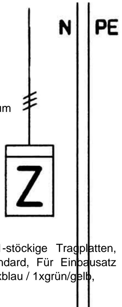
Striebel&John Abgangsleitung L116 Ausführung für 1-stöckige Tragplatten, Nennquerschnitt 16mm<sup>2</sup>, Polzahl 5, Zählerzugang Standard, Für Einbausatz 3-reihig, Form des Kabelschuhs Hülse, Farbe 3xbraun / 1xblau / 1xgrün/gelb,
