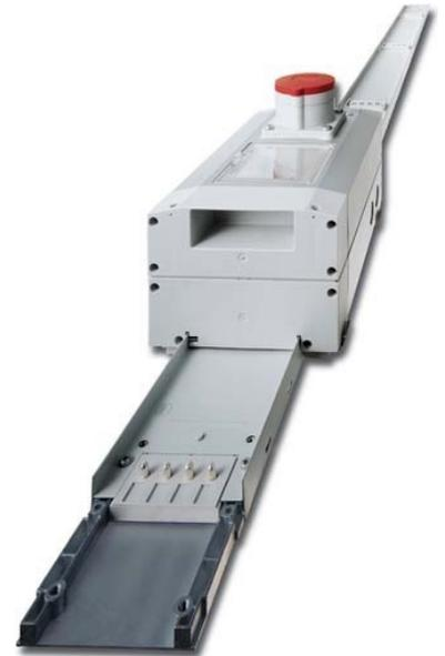
Siemens Indus.Sector Schienenkasten 100A BD01-100-2-0,5 Ausführung Einzel, Bemessungsstrom bei AC 50 Hz 100A, Polzahl 5, Anzahl der Leiter (ohne Erde) 4, Bemessungsspannung bei AC 50 Hz 400 ...
