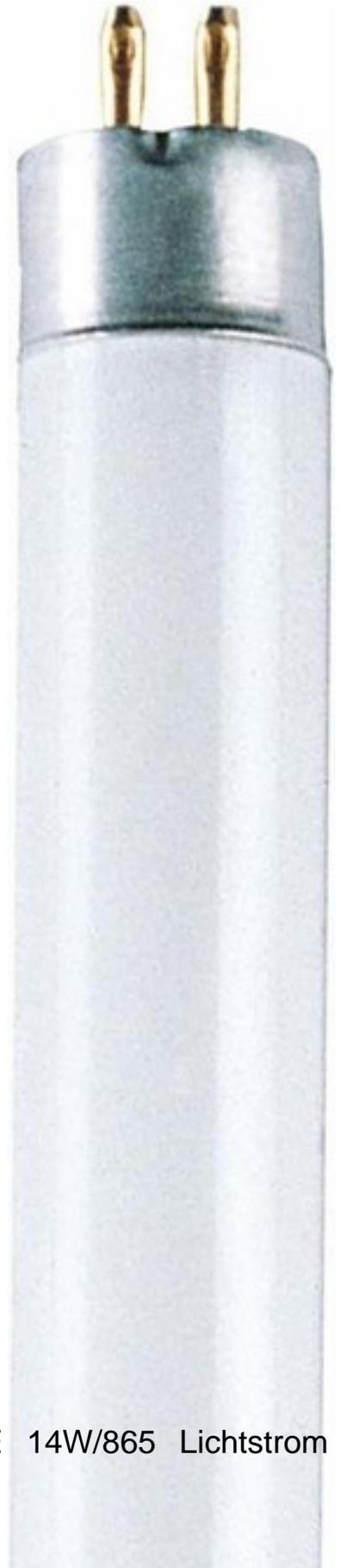
1100lm, Mittlere Nennlebensdauer 24000h, Energieeffizienzklasse A+, Lampenleistung 14W, Sockel G5, Farbwiedergabestufe 80-89 (Klasse 1B), Farbtemperatur 6500K, Lampenform Stab, Lampenlichtausbeute 79lm/W, Lichtfarbe 865, Lichtfarbe gemäß EN 12464-1 kühl >5300 K, Rohrdurchmesser 16mm, Länge 549mm, Farbe sonstige, Anwendung allgemein, Gewichteter Energieverbrauch in 1000 Stunden 16kWh, Nur für EVG-Betrieb geeignet
