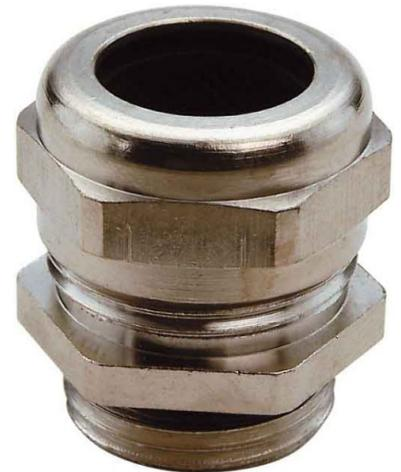
Schlemmer Verschraubung 4200802 Gewindeart metrisch, Gewindenenngröße metrisch/PG 12, Gewindelänge 13mm, Für Kabeldurchmesser 4 ...
