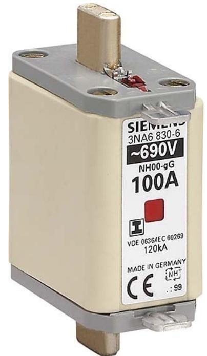
Siemens Indus.Sector NH-Sicherungseinsatz Gr00 100A690AC/250DC 3NA6830-6 Baugröße NH000, Bemessungsstrom 100A, Bemessungsspannung 690V, Betriebsklasse gL/gG (Ganzbereichs-Leitungsschutz/Ganzbereichs-Gerätesch.), Ausführung Kennmelder Kombikennmelder, Mit isolierten Griffflaschen, auch für Gleichspannungen bis 250 V.
