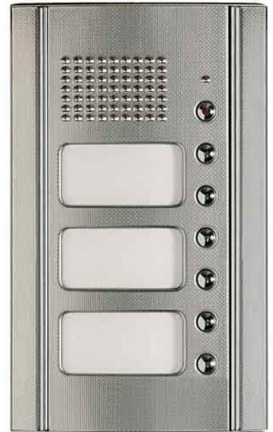
Legrand (SEKO) Frontblende Monoblock 333164 Anzahl der Ruftasten 6, Mit Abdeckung, Farbe Edelstahl, Installationstechnik Bus-System, Höhe 235mm, Breite 139mm, Tiefe 20mm, Monoblock Frontblende mit Lautsprecherjalousie, Lichttaste, 4 Ruftasten mit 2 Namensschildern und Schrifteinlagen (67 x 36 mm, für je 2 Namen), zur Abdeckung von 1 Lautsprecher- und 1 Ruftast-Modul, Montage vertikal.
