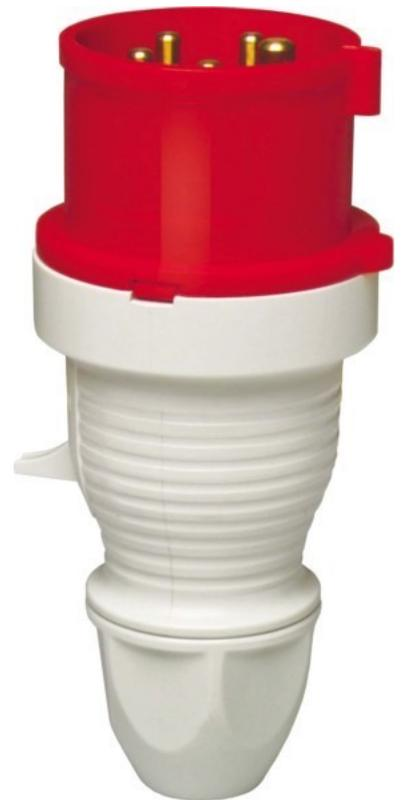
Walther Werke Stecker 32A 4P 400V 6h IP44 230406 IEC-Stromstärke 32A, UL/CSA-Stromstärke (wenn UL-Ausführung gewünscht) 30A, Polzahl 4, Spannung nach EN 60309-2 400 V (50+60 Hz) rot, Uhrzeit-Stellung 6h, Kennfarbe rot, RAL-Nummer 3000, Schutzart (IP) IP44, Anschlussstechnik Schraubklemme, Kabeleinführung Knickschutztülle, Steckrichtung gerade, Werkstoff Kunststoff, Stecker 32A 4P 400V 6h IP44 mit Kabelknickschutz
