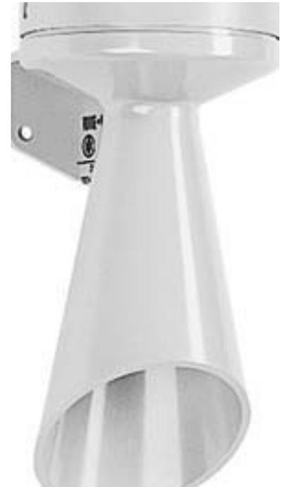
FHF Funke+Huster Kleinhupe 110 V AC 21220306 Gehäusefarbe grau, Werkstoff des Gehäuses Kunststoff, Lautstärke 95dB, Nennspannung 110V, Schutzart (IP) IP43, Stromart AC, Stromaufnahme 0,06A, Gehäuse: schlagfester Thermoplast (ABS), schmale und platzsparende Konstruktion, mit Schalltrichter für gerichtete Abstrahlung, Temperaturbereich: -20°C bis +60°C
