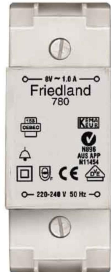
Novar Friedland Klingeltransformator D780 Primärspannung 240V, Sekundärspannung 1 8V, Sekundärstromstärke 1 1A, Max.
