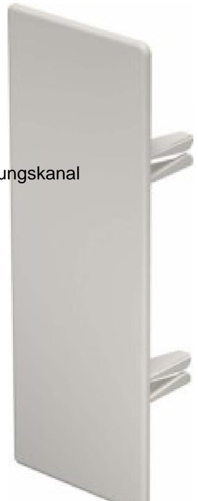
OBO Bettermann Vertr Endstück WDK HE60170CW Höhe 170mm, Breite 60mm, Ausführung links/rechts, Werkstoff Kunststoff, Werkstoffgüte PVC, Oberfläche unbehandelt, Farbe cremeweiß, RAL-Nummer 9001, Befestigungsart aufrastbar, Zum Verschließen der Enden von WDK-Kanälen
