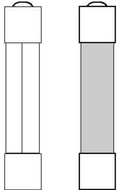
Eska G-Sicherungseinsatz 5x25mm M 6,3A m.Kennmelder 528.025
