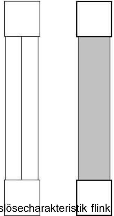
Eska G-Sicherungseinsatz F 16A 6,3x32mm 632.030 Auslösecharakteristik flink (F), Ausführung Glassicherung, Bemessungsstrom 16A, Bemessungsspannung 250V, Abmessungen 6,3x32 mm, Glasrohr mit Löschmittel gefüllt, Kontaktkappen aus vernickeltem Messing
