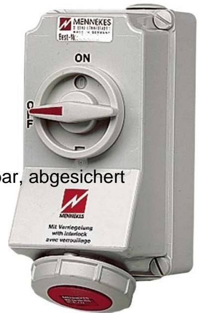
Mennekes Wanddose DUO 16A,7p,6h,400V,IP67 7306 IEC-Stromstärke 16A, Polzahl 7, Spannung nach EN 60309-2 400 V (50+60 Hz) rot, Uhrzeit-Stellung 6h, Kennfarbe rot, Schutzart (IP) IP67, Schalter mechanische Verriegelung, Ausführung des Schalters Hilfskontakte, Werkstoff des Gehäuses Kunststoff, Absicherung sonstige,
