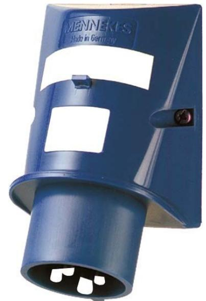
Mennekes Wandstecker 16A,4p,9h,230V,IP44 3342 IEC-Stromstärke 16A, Polzahl 4, Spannung nach EN 60309-2 230 V (50+60 Hz) blau, Uhrzeit-Stellung 9h, Kennfarbe blau, Schutzart (IP) IP44, Anschlussstechnik Schraubklemme, Bauform Wandgerätestecker (AP), Phasenwender, Steckrichtung rechtwinklig, Werkstoff Kunststoff,
