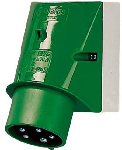
Mennekes Wandstecker 16A,5p,10h,>50V,IP44 2668 IEC-Stromstärke 16A, Polzahl 5, Spannung nach EN 60309-2 50-500 V (100-300 Hz) grün, Uhrzeit-Stellung 10h, Kennfarbe grün, Schutzart (IP) IP44, Anschlussstechnik Schraubklemme, Bauform Wandgerätestecker (AP), Steckrichtung rechtwinklig, Werkstoff Kunststoff,
