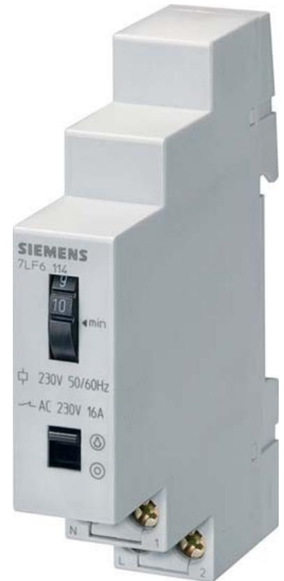
Siemens Indus.Sector Energiesparzeitschalter 3 bis 60min 7LF6115 Funktion mechanisch, Montageart DIN-Schiene, Breite in Teilungseinheiten 1, Einbautiefe 64mm, Anzahl der Schließer 1, Anzahl der Öffner 0, Anzahl der Wechsler 0, Steuerspannung 1 230 ...
