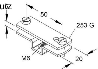
Niedax Abstandschellen 251 G Befestigungsart Leiter mit Schraubchelle, Leiterabmessungen 30x4 mm flach, Werkstoff des Halters Stahl, feuerverzinkt, Befestigungsart Halter Bohrung mit M Gewinde, Werkstoff des Trägers Stahl, feuerverzinkt, Werkstoff des Überlegers Stahl, feuerverzinkt, Werkstoff des Unterteils Stahl, feuerverzinkt, Gewindemaß metrisch 6, Bandeisen Abstandschelle zum Anschrauben
