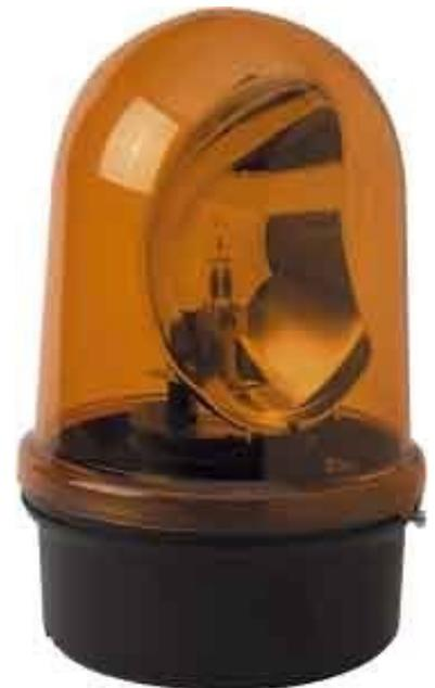
Novar Friedland Drehspiegelleuchte 24V AC/DC E4050/3+7rt Nennspannung 24V, Stromaufnahme 1,6A, Leistung 35W, Kalottenfarbe rot, Leuchtmittel Halogen, Optik Spiegel, Für Innen- und Außenmontage, hohe Lebensdauer.
