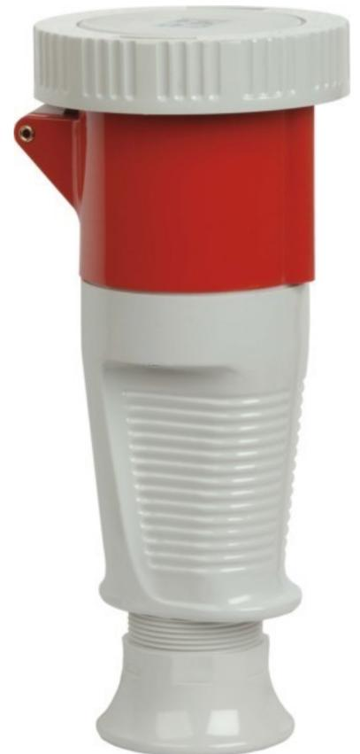
Walther Werke Kupplung 125A 5P 400V 6h IP67 379 IEC-Stromstärke 125A, UL/CSA-Stromstärke (wenn UL-Ausführung gewünscht) 100A, Polzahl 5, Spannung nach EN 60309-2 400 V (50+60 Hz) rot, Uhrzeit-Stellung 6h, Kennfarbe rot, RAL-Nummer 3000, Schutzart (IP) IP67, Anschlussstechnik Schraubklemme, Steckrichtung gerade, Kabeleinführung Verschraubung, Werkstoff Kunststoff, Kupplung 125A 5P 400V 6h IP67 mit Trompetenschraubung
