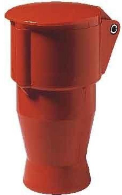
Elektra Tailfingen Cekon-Kupplungsdose CC 332/6H IEC-Stromstärke 32A, Polzahl 3, Spannung nach EN 60309-2 230 V (50+60 Hz) blau, Uhrzeit-Stellung 6h, Kennfarbe blau, Schutzart (IP) IPX4, Anschlussstechnik Schraubklemme, Steckrichtung gerade, Kabeleinführung Knickschutztülle, Werkstoff Kunststoff, Isogekapselt
