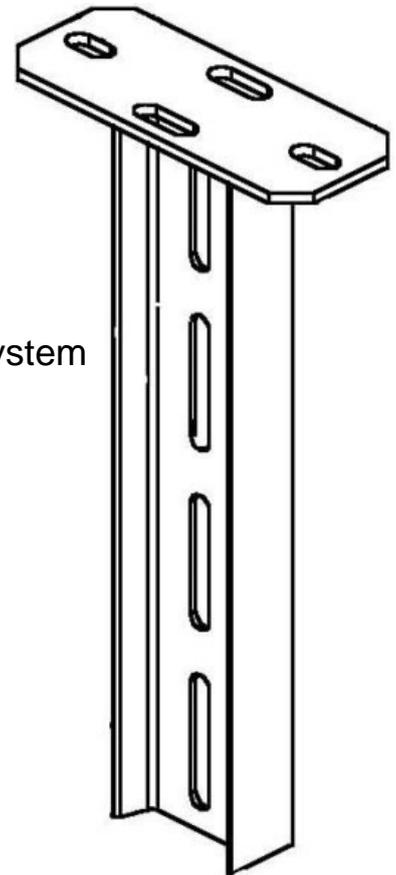
Niedax Hängestiel HI 80/2000 Länge 2000mm, Profilbreite 80mm, Ausführung I-Profil, Werkstoff Stahl, Werkstoffgüte sonstige, Oberfläche tauchfeuerverzinkt, Farbe ohne,
