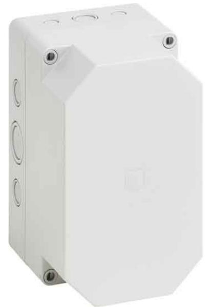
Spelsberg Leergehäuse TK PC 1811-13f-m Höhe 180mm, Breite 110mm, Tiefe 137mm, RAL-Nummer 7035, Anbaumöglichkeit, Werkstoff des Gehäuses Kunststoff, Oberfläche sonstige, Schutzart (IP) IP66, Art des Deckels geschlossen, IP 66, 180 x 110 x 137 mm, Leergehäuse  $U_i=690$  V, Kasten und Deckel: glasfaserverstärktes Polycarbonat, grau ähnlich RAL 7035
