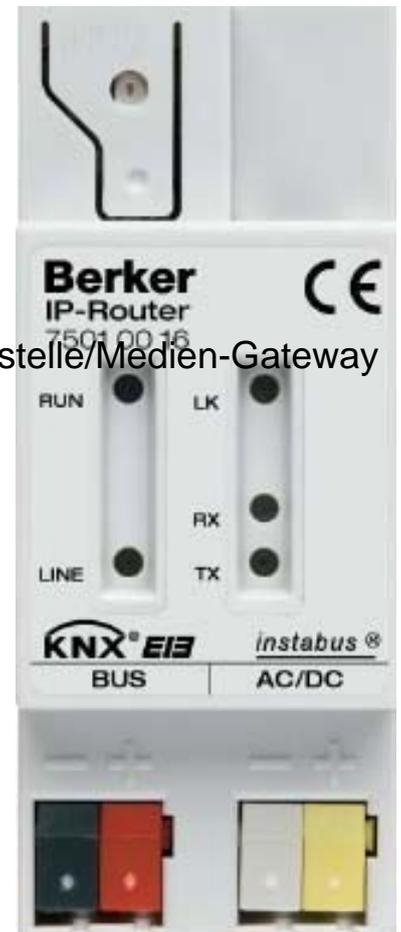
Berker IP-Router REG instabus KNX /EIB lichtgrau 75010016 Bussystem KNX, Andere Bussysteme ohne, Ausführung Schnittstelle Ethernet, Montageart REG, Breite in Teilungseinheiten 2, Mit LED-Anzeige, Betriebsspannung 24V, Protokoll sonstige, Schutzart (IP) IP20, IP-Router REG KNX lichtgrau Betriebsspannung 24 V~/= Betriebstemperatur -5 ...
