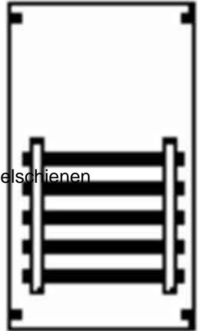
Striebel&John Verteilerfeld 1V002A Höhe 450mm, Breite 250mm, Mit Abdeckung, Polzahl 5, Schienenabstand 40mm, Schienenhöhe 12mm, Schienenstärke 5mm, Max.
