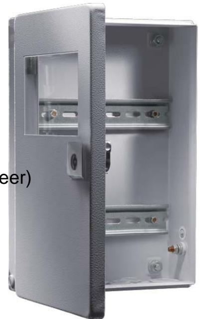
Rittal Bus-Gehäuse 800x300x155mm BG 1579.450 Breite 800mm, Höhe 300mm, Tiefe 155mm, Werkstoff Stahl, Ausführung der Oberfläche pulverbeschichtet, Farbe grau, RAL-Nummer 7035, Mit Montageplatte, Wandbefestigung möglich, Anzahl der Türen 1, Schutzart (IP) IP65, Bus-Gehäuse BG, Farbe: RAL 7035, Lieferumfang: Gehäuse mit Tür, Sichtfenster in der Tür, Beschreibung: Gehäuse mit Tür aus Stahlblech, lackiert mit Sichtscheibe aus Polycarbonat.
