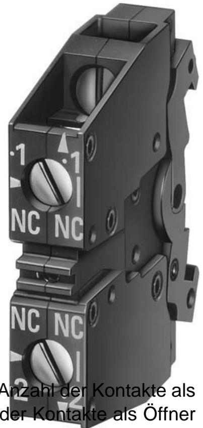
Siemens Indus.Sector Schaltelement 1S 1S 3SB3400-0D Anzahl der Kontakte als Wechsler 0, Anzahl der Kontakte als Schließer 2, Anzahl der Kontakte als Öffner 0, Bemessungsbetriebsstrom I<sub>e</sub> bei AC-15, 230 V 10A, Ausführung des elektrischen Anschlusses Schraubanschluss, Montageart Frontbefestigung, Betätiger-/Melderkomponente, Schaltelement mit 2 Schaltgliedern, Schraubanschluss
