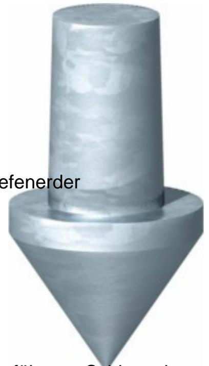
OBO Bettermann Vertr Erderspitze 20mm 1819 20BP Ausführung Schlagspitze, Erderdurchmesser 20 mm, Werkstoff Temperguss, Oberfläche unbehandelt, Geeignet für Aufnahmesystem sonstige, DIN 48852, Form Sp, für System BP.
