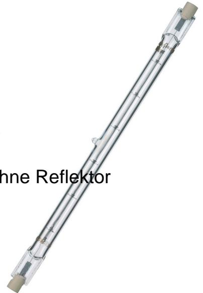
Radium Lampenwerk Halogenlampe klar RJH-TS1000W230/C/R7S Lichtstrom 22000lm, Mittlere Nennlebensdauer 2000h, Energieeffizienzklasse C, Lampenleistung 1000W, Lampenspannung 230 ...
