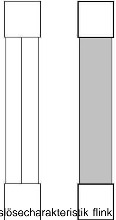
Eska G-Sicherungseinsatz F 10A 6,3x32mm 632.027 Auslösecharakteristik flink (F), Ausführung Glassicherung, Bemessungsstrom 10A, Bemessungsspannung 250V, Abmessungen 6,3x32 mm, Glasrohr mit Löschmittel gefüllt, Kontaktkappen aus vernickeltem Messing
