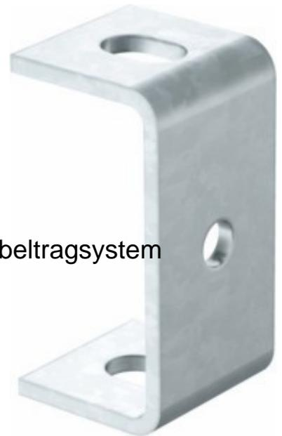
OBO Bettermann Vertr Deckenbügel stahl DB FT Länge 40mm, Breite 40mm, Höhe 80mm, Ausführung sonstige, Werkstoff Stahl, Werkstoffgüte sonstige, Oberfläche tauchfeuerverzinkt, Farbe ohne, Deckenbügel zur Gewindestangenabhängung mit Befestigungsloch 13 mm.
