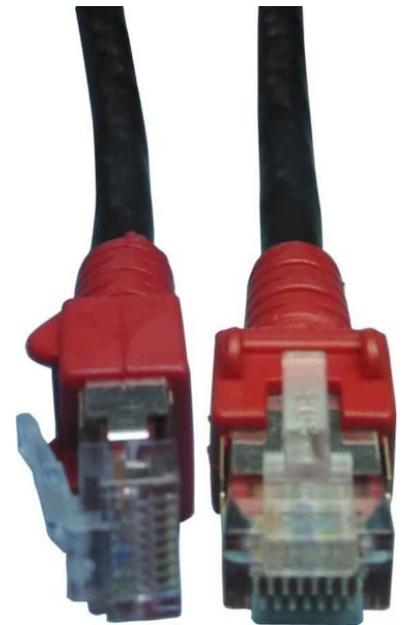
CommScope/AMP Netconn Patchkabel X-Over SF/UTP RJ45/RJ45 TN-5000X sw 5,0m Kabeltyp SF/UTP, Kategorie 5E, Länge 5m, Steckverbindertyp Anschluss 1 RJ45 8(8), Steckverbindertyp Anschluss 2 RJ45 8(8), Mantel-Farbe schwarz, Knickschutztülle angespritzt, Rasthebelschutz, Farbe der Knickschutztülle rot, Ausführung flammwidrig, Halogenfrei, Kabelkonstruktion 4x2, AWG-Querschnitt 26, Pinbelegung gekreuzt, Die Patchkabel sind beidseitig mit geschirmten RJ45-Steckverbindern von Stewart bestückt.
